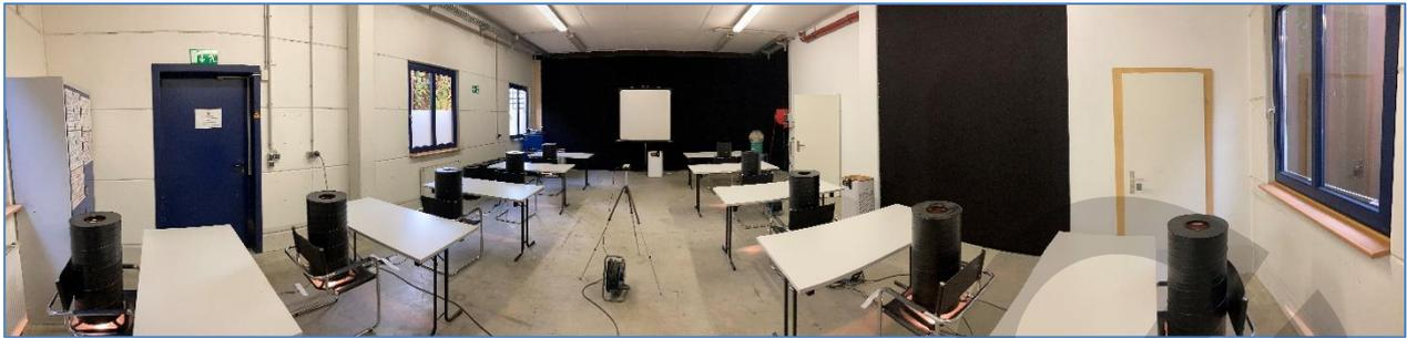
**Bild 4.1:** asecos PURIFIAR.620 im Unterrichtsraum zur Ermittlung der Reduzierung von DEHS-Prüfaerosolkonzentrationen gemäß VDI EE 4300 Teil 14
