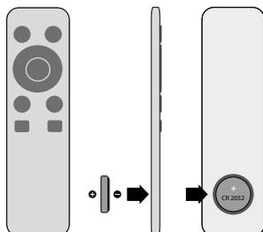
Dit product wordt geleverd met een afstandsbediening, die knoopcellen gebruikt. Haal bij langer tijd van niet-gebruik de cellen eruit. Tussen de knoppen op de afstandsbediening en het bedieningspaneel bestaat een één op één overeenkomst. De functies en werkwijzen zijn over het algemeen dezelfde.
