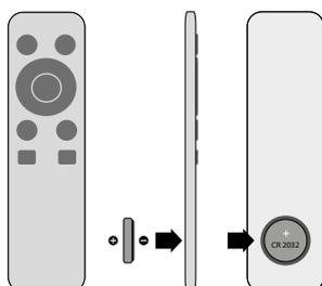
Este purificador se suministra con un mando a distancia que funciona con pilas de botón. En caso de no utilizarlo durante un periodo de tiempo prolongado, extraiga las pilas. Cada tecla del mando a distancia se corresponde con una tecla del panel de mando. En general, las funciones y los métodos de funcionamiento son idénticos.
