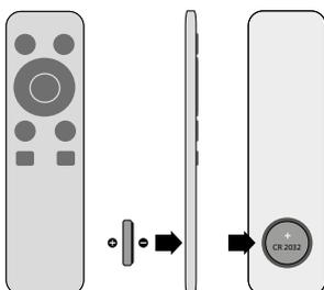
Dieses Produkt wird mit einer Fernbedienung geliefert, welche Knopfzellen verwendet. Bei längerer Nichtnutzung, nehmen Sie die Zelle heraus. Zwischen den Tasten auf der Fernbedienung und dem Bedienfeld besteht eine Eins-zu-Eins-Entsprechung. Die Funktionen und Betriebsmethoden sind im Allgemeinen gleich.
