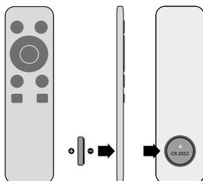
Ce produit est livré avec une télécommande qui utilise des piles boutons. En cas d'absence d'utilisation prolongée, retirez les piles. Il y a une correspondance totale entre les boutons sur la télécommande et le panneau de commande. Les fonctions et les méthodes de fonctionnement sont généralement identiques.
